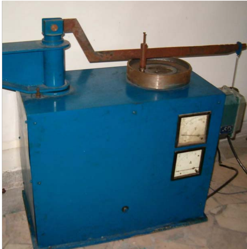
Mașină pentru încercarea la frecare – uzare a cuplei disc-cilindru
